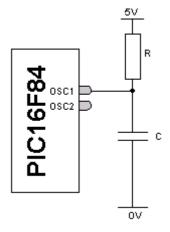
La vitesse d'horloge sera fonction de R, C et de la tension d'alimentation. OSC2 est la patte de sortie d'horloge.
