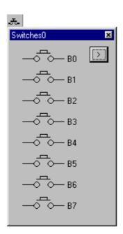
Le composant Interrupteurs de Flowcode permet de connecter une rangée de 1 à 8 interrupteurs au microcontrôleur.
