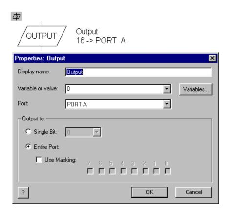
L'icône Sortie permet d'envoyer la valeur ou le contenu d'une variable au port et/ou aux bits spécifiés.
