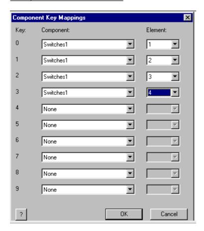
La commande 'Touche 0 à 9' du menu 'Edition' vous permet d'utiliser les touches numériques de 0 à 9 pour piloter des composants attachés au microcontrôleur. Par exemple, si vous disposez d'une rangée de 8 boutons poussoirs connectés au microcontrôleur, vous pouvez choisir d'utiliser les touches 1 à 8 pour simuler l'enfoncement puis le relâchement de ces Interrupteurs lorsque l'algorigramme est simulé.
