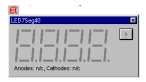
Le composant afficheur à LED 7 segments dispose d'une seule macro pour contrôler l'affichage. Afin de réduire le nombre de connexions avec le microcontrôleur, l'afficheur doit être multiplexé. Dans ce cas chaque afficheur doit être montré successivement afin de donner l'illusion que les 4 digits sont affichés en même temps.
