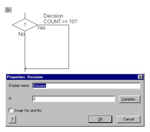
Les icônes de décision vous permettent de tester une condition et d'effectuer certains traitements en fonction du résultat du test.
