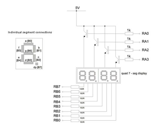
Le quadruple afficheur 7 segments doit être connecté au microcontrôleur comme montré dans le diagramme ci-dessus. Typiquement ce périphérique doit être connecté au microcontrôleur via les ports suivants :
