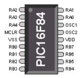
Les pattes (pins) RB0 à RB7 sont collectivement nommées 'Port B'. Chaque patte peut être configurée en entrée ou en sortie. Quand vous choisissez un PICmicro dans Flowcode, chaque patte sera déclarée soit en entrée soit en sortie pour vous. Le Port B dispose de 8 pattes qu'on peut imaginer comme la représentation d'un octet. Le Port B est en fait contrôlé par un octet dans la mémoire RAM du PICmicro. Pour chaque patte du port, on parle aussi souvent de
