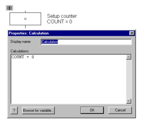
L'icône de Calcul permet la modification des variables. Elle peut être utilisée pour vérifier des entrées ou créer des sorties.
