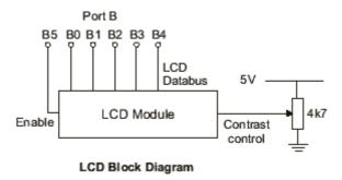
L'afficheur LCD doit être connecté au microcontrôleur comme montré sur le diagramme.
