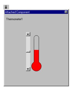
Le thermomètre est un composant analogique et nécessite un microcontrôleur disposant de un ou plusieurs convertisseurs d'entrée analogique - numérique. Ce composant enregistre les variations de tension par rapport à une tension de référence. La tension résultante est enregistrée en mémoire.
