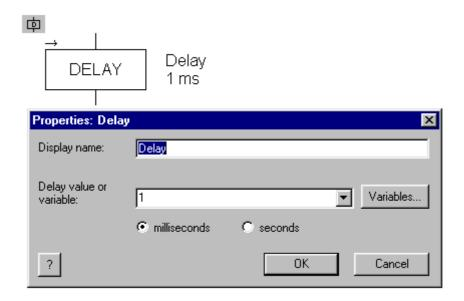
Les icônes Pause permettent d'ajuster le timing de votre programme et d'en ralentir l'exécution.
