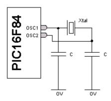
Dans les deux cas, vous avez besoin de spécifier la fréquence d'horloge et le type d'horloge à la fois dans Flowcode et dans votre programmateur de PIC : la circuiterie interne de chaque système est différente et doit être configurée lors de la programmation du composant.
